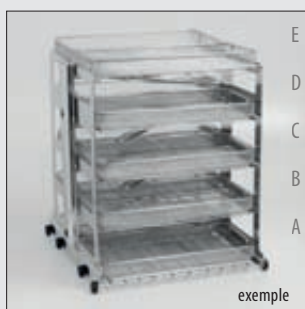
C701 - Chariot avec 5 niveaux et 4 bras de lavage. Les trois premiers niveaux sont amovibles. Hauteurs utiles de 82 mm à 515 mm
