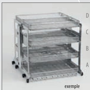
C501 - Chariot avec 4 niveaux et 3 bras de lavage; étagère supérieure et bras amovibles. Hauteurs utiles: A) 90 mm B) 90 mm C) 90 mm D) 70 mm
