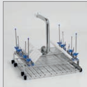
C58 - Chariot avec 2 niveaux pour microchirurgie. 16 connexions pour instruments creux et 16 buses. Hauteur maximum de 65 mm
