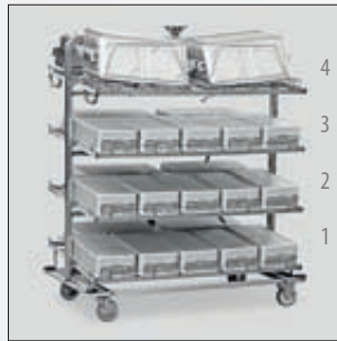
D C690 - Chariot de lavage pour unités de stérilisation avec système d'injection. Capacité jusqu'à 21 U.S. de dimensions LxPxH 600x300x300mm.
