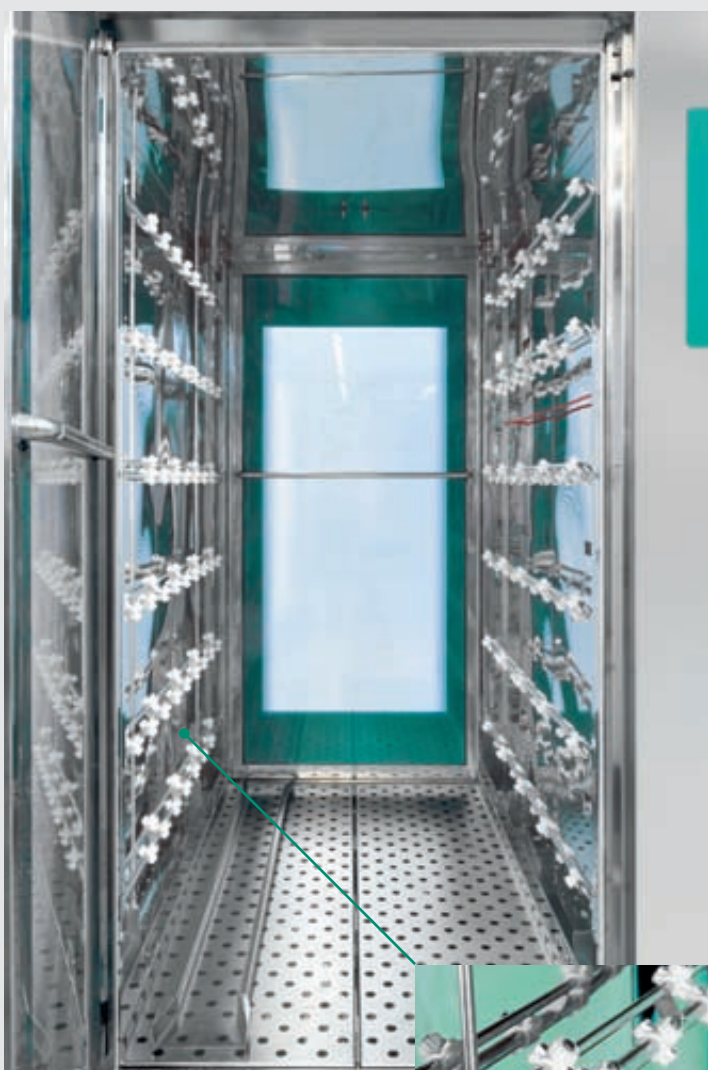
Exemple d'une chambre de lavage à la désinfection chimique.
